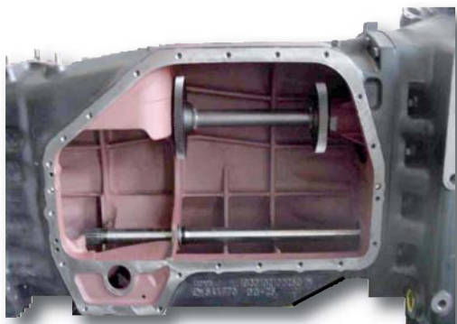
De cartridge is weg. Boven, de ingaande as. Het tandwiel links drijft de hydropomp aan. Het tandwiel rechts, rechtstreeks het mechanische deel. Onder, de as voor de vierwielaandrijving.
