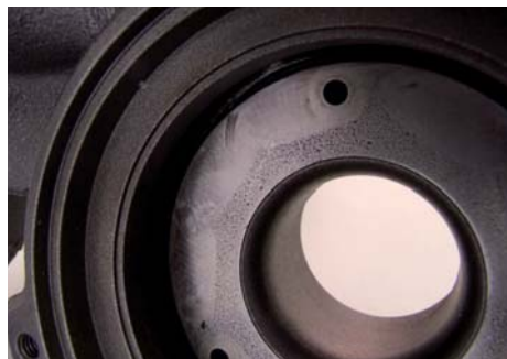
In de gereviseerde turbo liggen de vanen tegen een ruw bewerkt oppervlak. In de originele turbo op de rechterfoto tegen een spiegelglad vlak.
