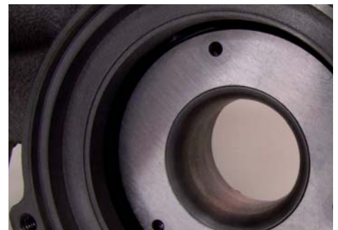
In de gereviseerde turbo liggen de vanen tegen een ruw bewerkt oppervlak. In de originele turbo op de rechterfoto tegen een spiegelglad vlak.
