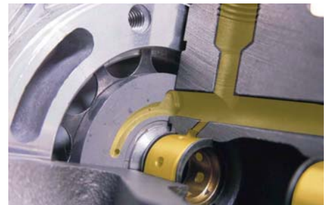
De turbo-as (hier weggelaten) is zwevend gelagerd. Zolang er geen oliedruk is, geeft dat speling. Olie in de sleuf in de achterplaat van het compressorwiel verzorgt de axiaalagering.
