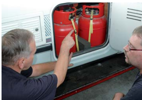
Leermomentje: "Hoe vast is vast bij gasflessen", vraagt de keurmeester aan Bakels als hij het twee-de brandstofsysteem van een camper controleert.
