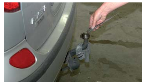
Zo'n trekhaakkogel is vrijwel altijd aan de maat. "Toch controleren", weet Bakels. "Ik heb er eens een gehad die aan beide zijanten was vlakgeslepen. Had de eigenaar gedaan om zijn fietsendrager makkelijker te kunnen monteren."
