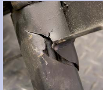
Scheuren in dragende delen door ondeugdelijke vering.
