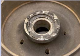
Met grof geweld een lager op zijn plaats houden.
