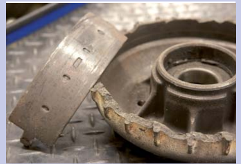
Extreme verhitting doordat de gebruiker vergat de handrem eraf te doen.
