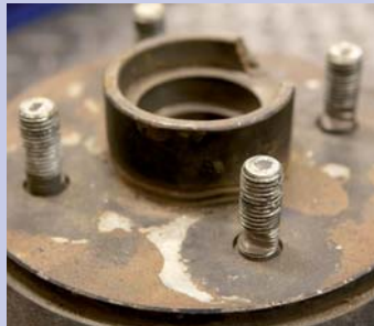
Weggevreten draadeinden omdat wielmoeren niet goed zijn vastgezet.
