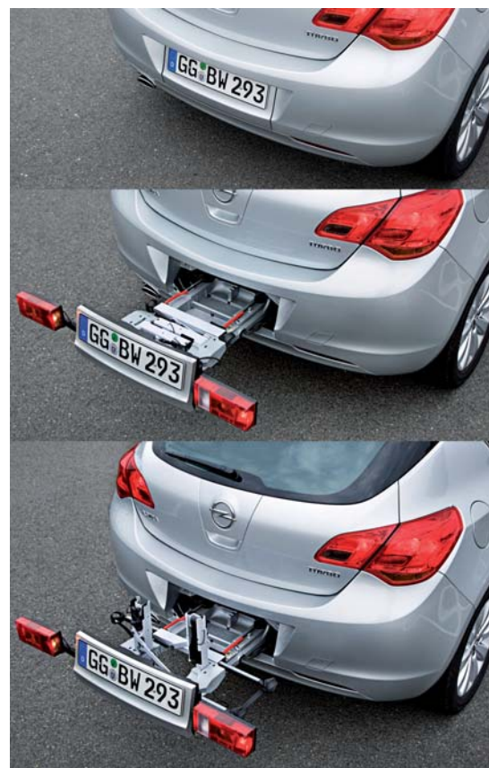
Uit de Corsa neemt Opel de handige uitschuifbare fietsendrager over. Uittrekken, steunen uitklappen, verlichting erop schroeven, klaar.
